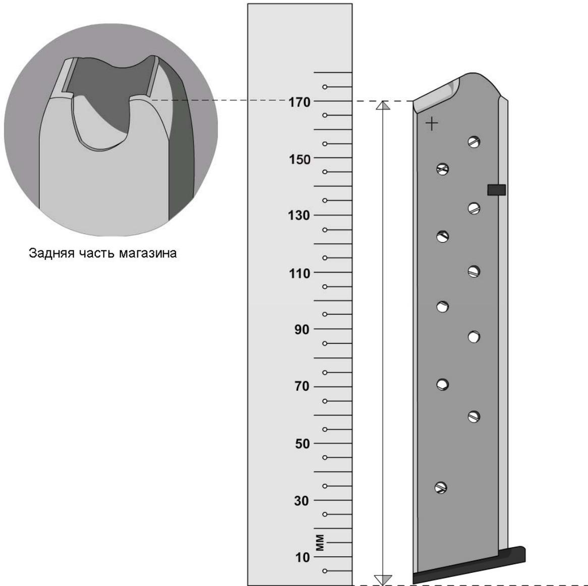
Магазин размещается вертикально на ровной поверхности. Измерение проводится от поверхности вверх до задней части выемки магазина, как показано на рисунке. Разрешены только ровные, прямые, жесткие магазины (т.е. гибкие, гнущиеся, J-, L-, T-образные и им подобные магазины запрещены).
